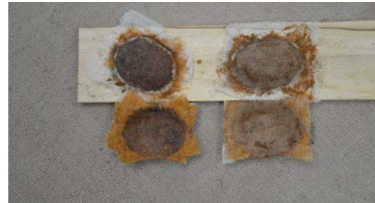
図 11 和紙の離型材としての試作
