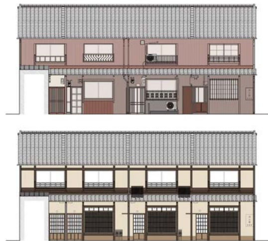
図7 東棟立面図(上:改修前、下:改修後)
