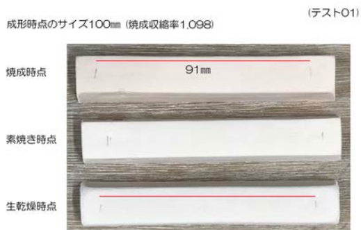
資料03 坯土焼成収縮率テスト(長谷川陶料調整)
