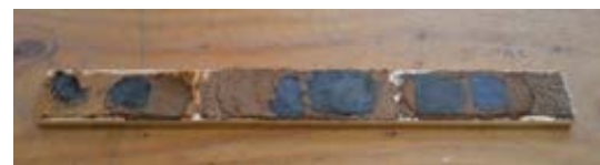
図 15 布、木屎、灰炭の盛り付け
