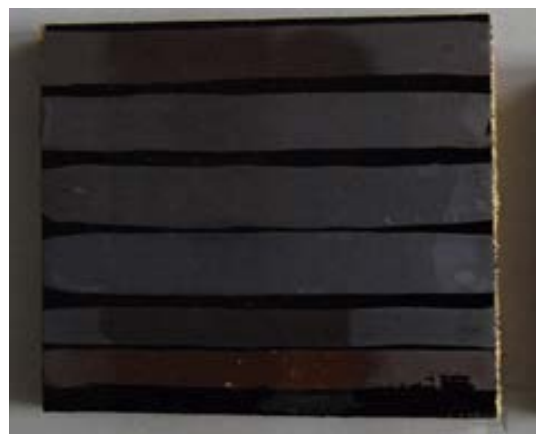
図10 鉛白を藍汁で染め弁柄を混ぜ合わせた方法のテストピース
