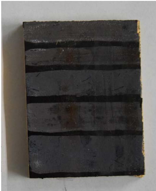
図7 鉛白、藍汁、弁柄を同時に混ぜ合わせ紫色を出す方法のテストピース
