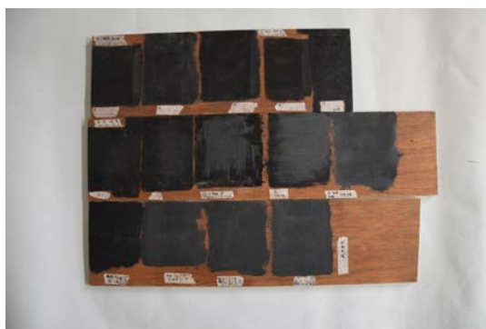
図1 錆漆テストピース
