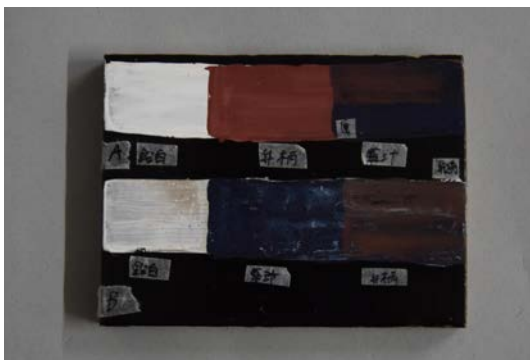
図8 一色ずつ乾燥させ、塗り重ねていく方法のテストピース
