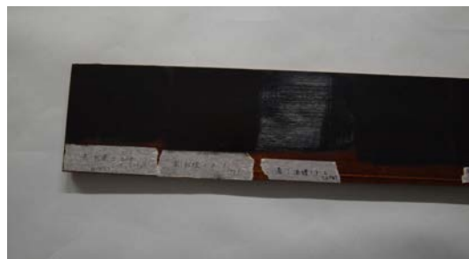
図6 塗りのテストピース
