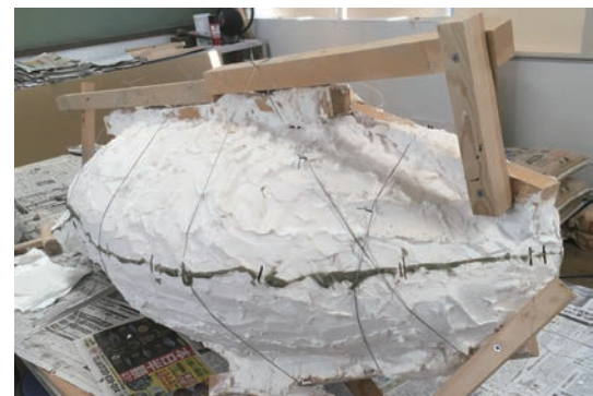
図4 型の歪を抑制する角材(筆者撮影)
