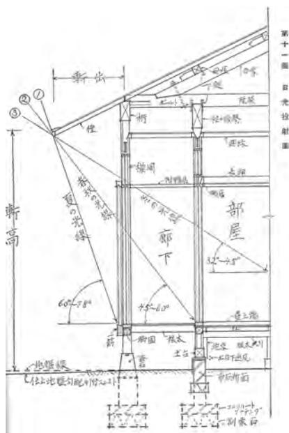
図 1-15 日光投射図<sup>17)</sup>
