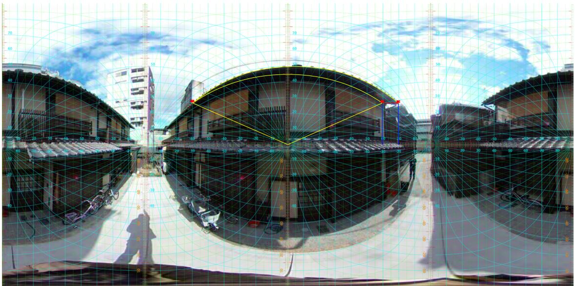
図6 軒先を用いた方位角の補正
