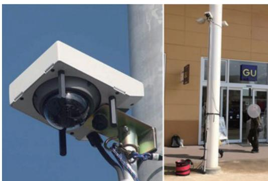
図3 「View Pole」カメラ部および、設置状況
