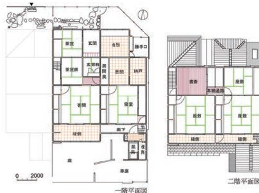
図3 実測図(平面)
