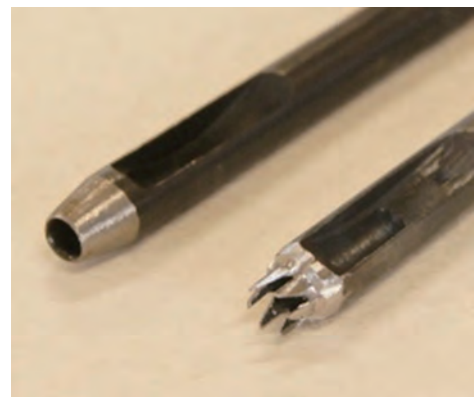
図2 厚貝切り抜き用回転式切削工具と加工前のレザークラフト用パンチ
